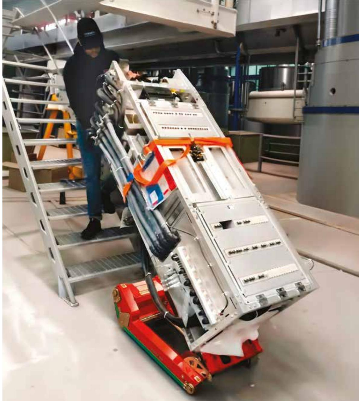
Skipper ist mit speziellen rutschfesten und spurenfreien Gummiraupen ausgestattet. Er hat eine Tragfähigkeit bis zu 400 kg und verfügt über zwei unabhängige Motoren, die es ermöglichen, ihn auch in sehr engen Räumen zu bewegen.
